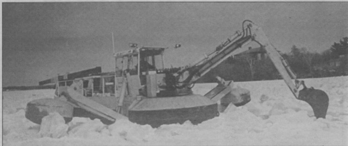
Surnommée «la grenouille», la machine amphibie d'Eco Technologies permet d'accomplir de nombreuses tâches, dont la destruction d'embâcles.
