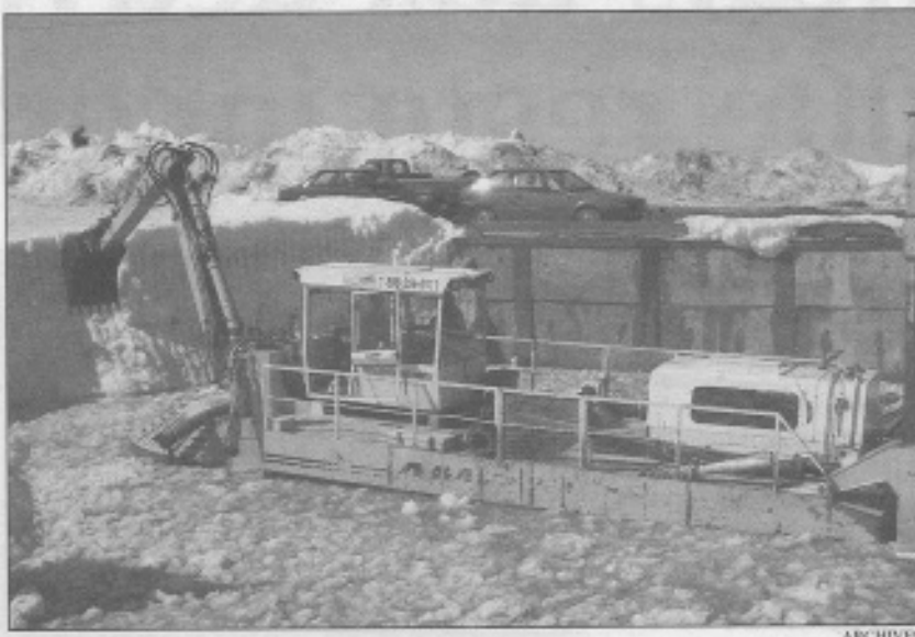
L'Amphibex mesure 11 mètres de long, pèse 22 tonnes métriques et peut atteindre une vitesse maximale de 8 noeuds sur l'eau.
